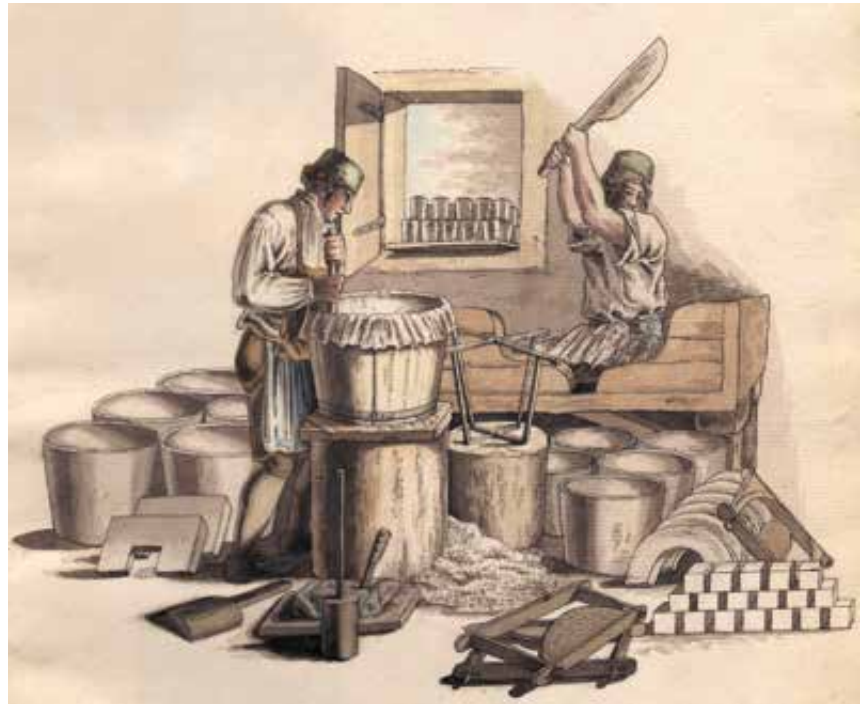
oben: Um den hohen Bedarf an Feuerfestmaterialien decken zu können, unterhielten die Blaufarbenwerke eigene Töpfereien. Hier wurden u. a. die Schmelztiegel, die sogenannten Häfen, aus einer geeigneten Tonmischung geformt. Abbildung von A. F. Winckler, 1790. Repro: Mike Haustein
