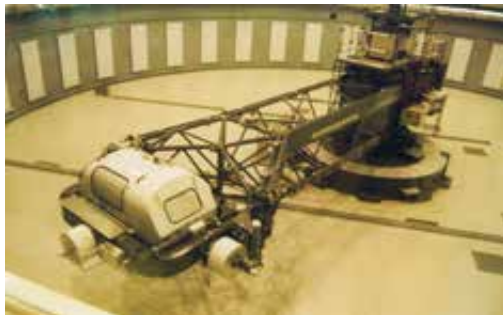
Humanzentrifuge im damaligen Institut für Luftfahrtmedizin, um 1985
