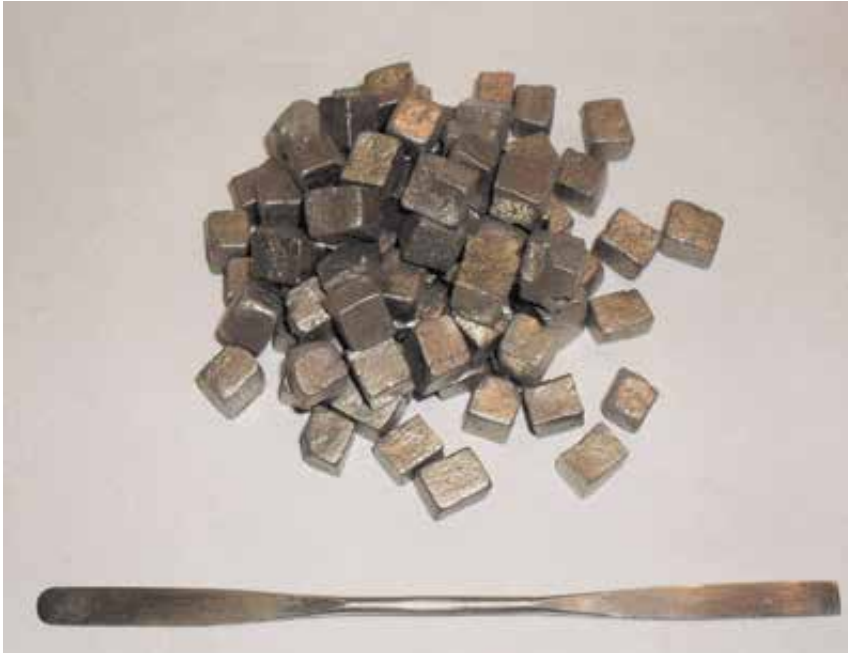
Im 19. Jahrhundert gehörte das in Form kleiner Kuben produzierte Würfelnickel zu den innovativsten Produkten der Blaufarbenwerke Niederpfannenstiel und Oberschlema. Es wurde u. a. zur Argentanfabrikation für die Auer Besteckindustrie eingesetzt. Präparat im Besitz des Fördervereins Schindlers Blaufarbenwerk e.V. Foto: Mike Haustein
